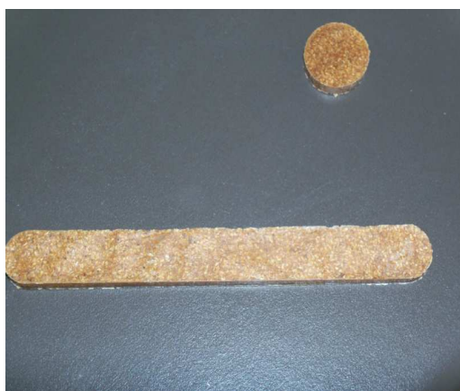
Figure 3 : Image des échantillons pour les tests rhéologique et mécanique.
