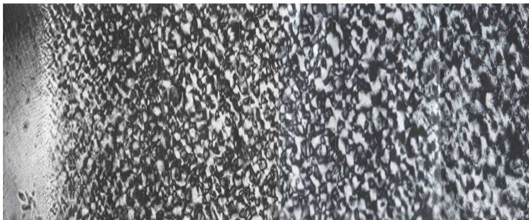
Bord Cœur Figure 2 : Évolution de la morphologie du PP du bord au cœur de la pièce à T_{\text{moule}} = 30^{\circ}\text{C} ; l'observation panoramique est réalisée sur une épaisseur de 1,75mm
