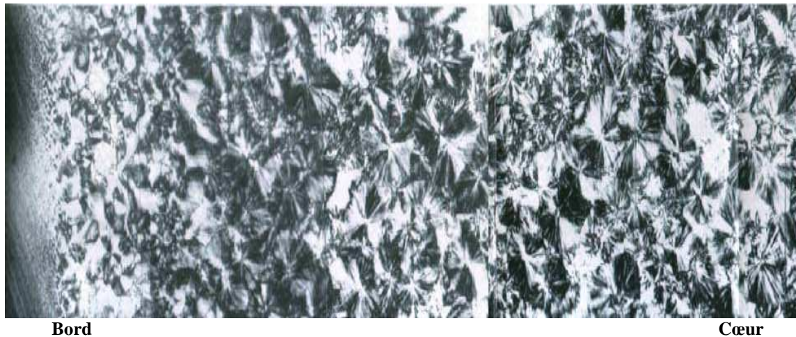
Figure 3 : Évolution de la morphologie du PP du bord au cœur de la pièce à T_{\text{moule}} = 100^{\circ}\text{C} ; l'observation panoramique est réalisée sur une épaisseur de 1,75mm
