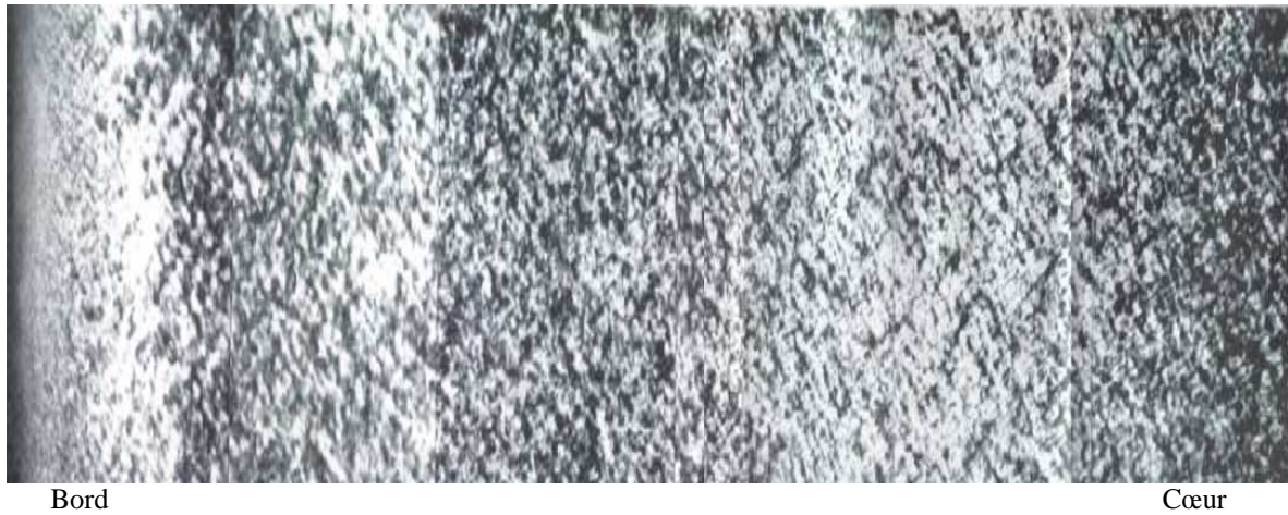
Figure 4 : Évolution de la morphologie du PP pur + 0.1% Talc dans l'épaisseur de la pièce (T moule = 100°C) ; l'observation panoramique est réalisée sur une épaisseur de 1,75mm.
