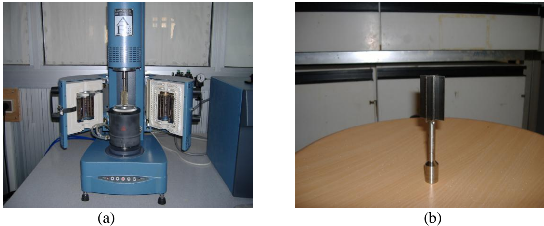
Figure 3 : Photos de (a) Rhéomètre 2000, (b) la géométrie vane
