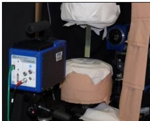
Figure 2 : Montage expérimentale de thermographie infrarouge
