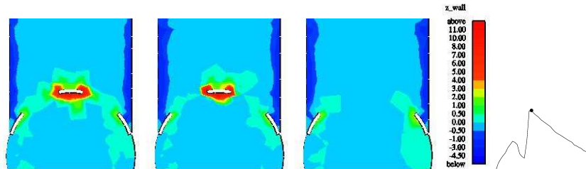
Figure 6 : Composante z du frottement pariétal dans le plan z=0 au maximum de débit. Cas 2, 6 et 4
