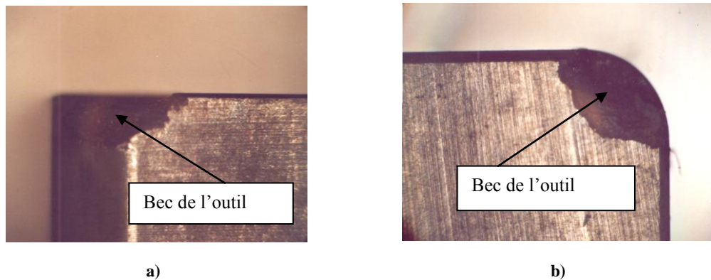
Figure 10 : Effondrement du bec de la céramique CC650 sur les surfaces en dépouille (a) et d'attaque (b), V_c=120\text{m/min} , f=0.08\text{mm/tr} , a_p=0.5\text{mm} .
