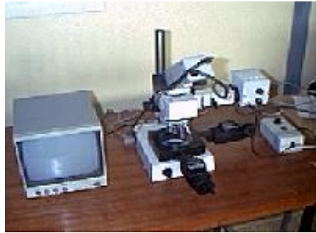
Figure 3 : Microscope optique équipé d'une caméra CCD pour la mesure de l'usure
