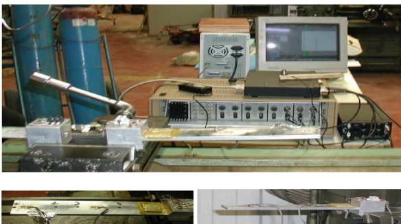
Figure 1 : Essai d'impact au marteau de choc : instrumentation et spécimen d'essai.
