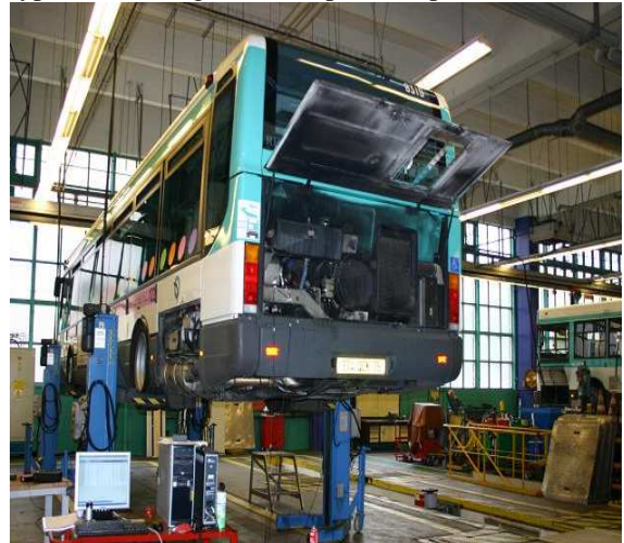
Figure 2 – Autobus Agora Line en préparation pour les essais vibratoires
